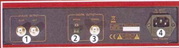
1 - Sortie analogique asymétrique sur prise Cinch à contact doré. 2 - Sortie numérique optique Toslink pour utilisation d'un convertisseur extérieur. 3 - Sortie numérique coaxiale Cinch SPDIF. 4 - Embase de raccordement pour le cordon secteur.
