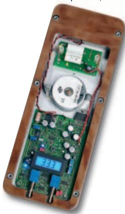
**GENAUER ABGLEICH:** Weil die Ambient-Motorsteuerung eine eigene Sinusschwingung herstellt, ist eine Drehzahl-Feineinstellung möglich.
