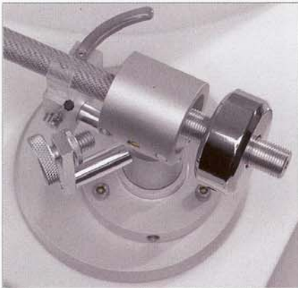
Die Antiskating-Kraft liefert ein im Abstand zum Arm justierbarer Magnet
